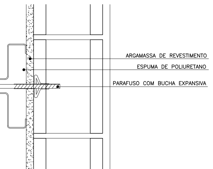
DETALHE FIXAÇÃO BATENTE METÁLICO ESCALA 1:5
