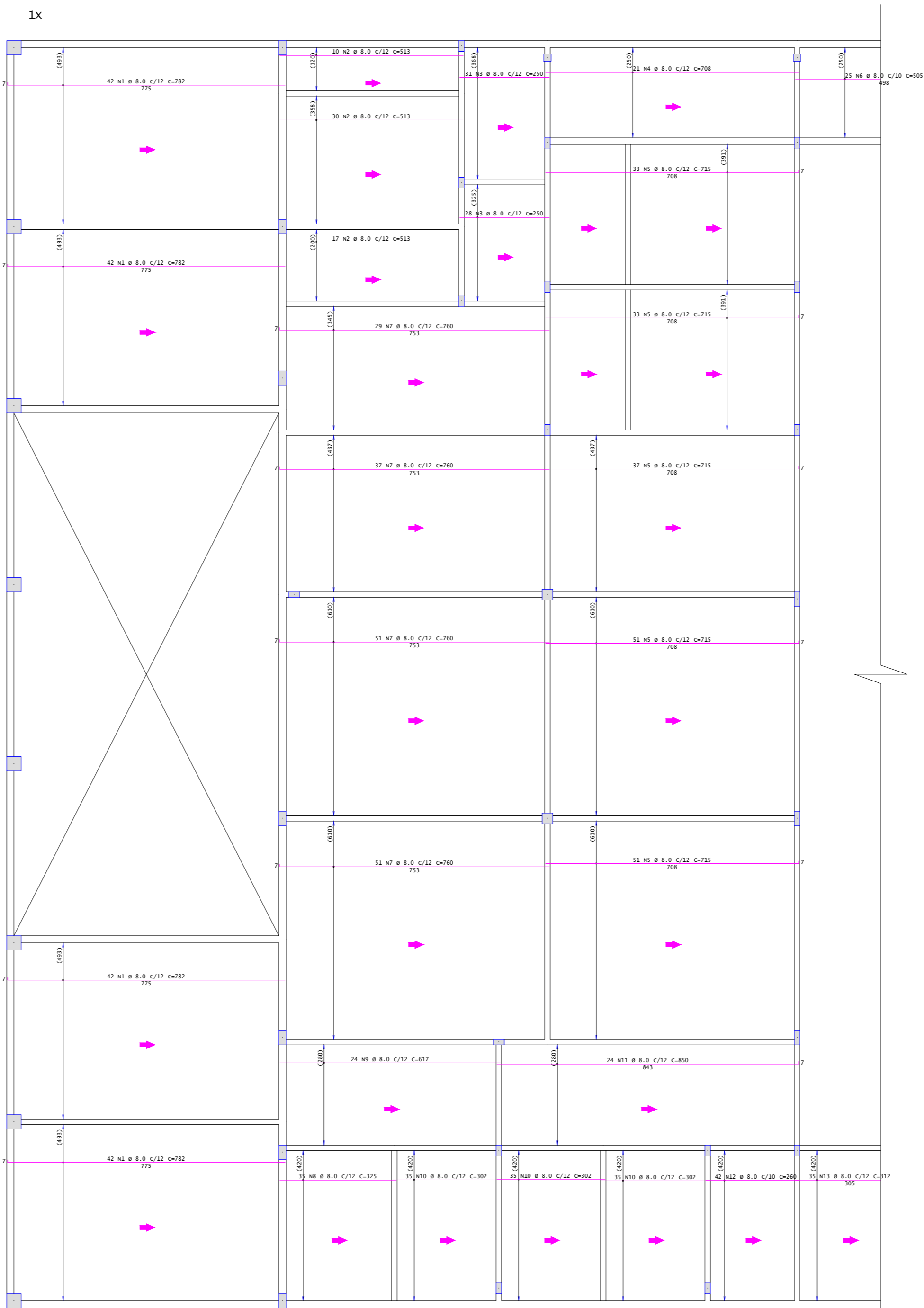
Detalhamento Genérico das Armadura positiva principal das lajes
