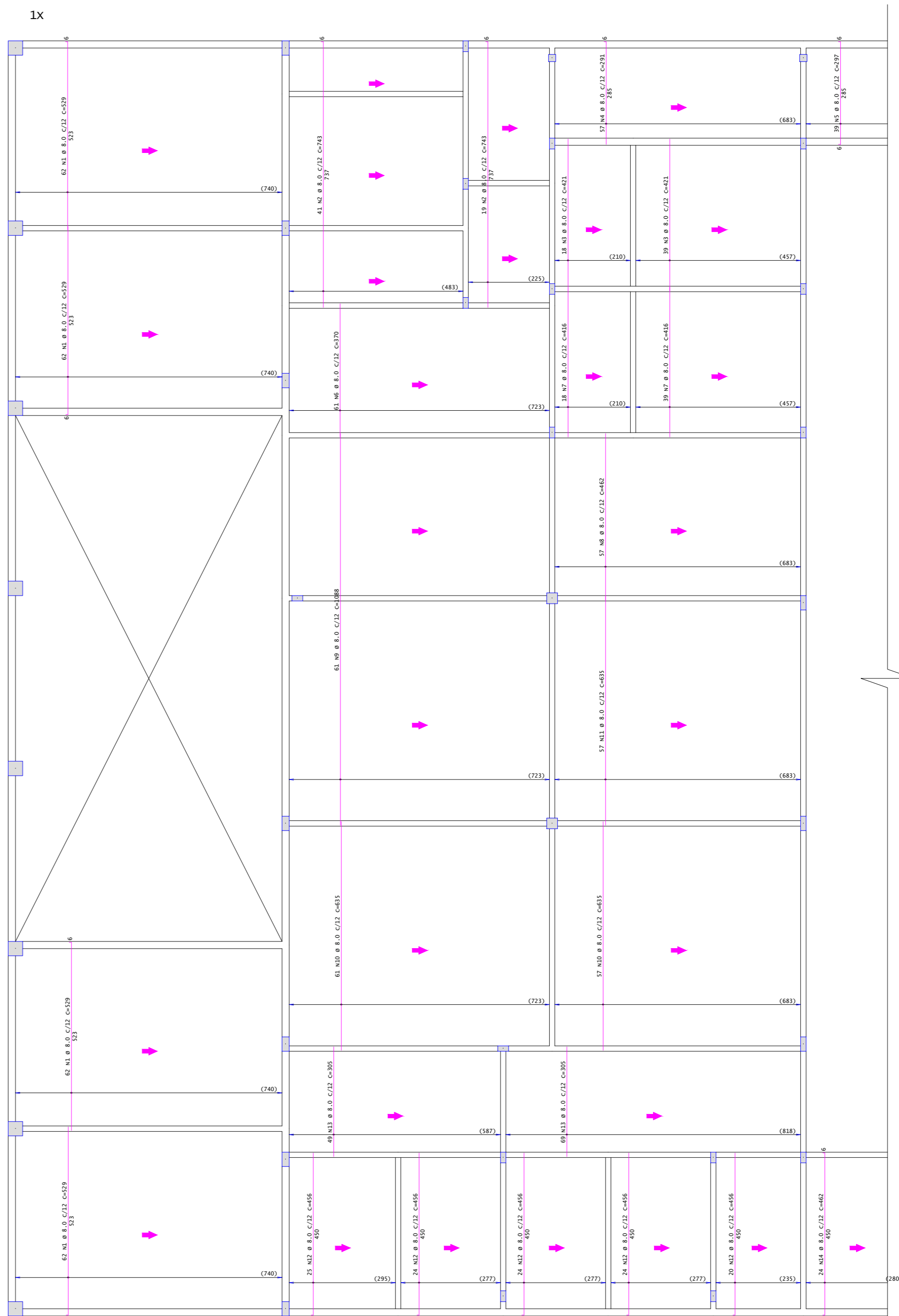
Detalhamento Genérico das Armadura positiva secundaria das lajes
